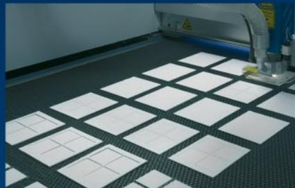
Durch moderne Laserverfahren ist eine sehr variable Bearbeitung der Geometrie und gezielte Strukturierung der Oberflächen möglich.
