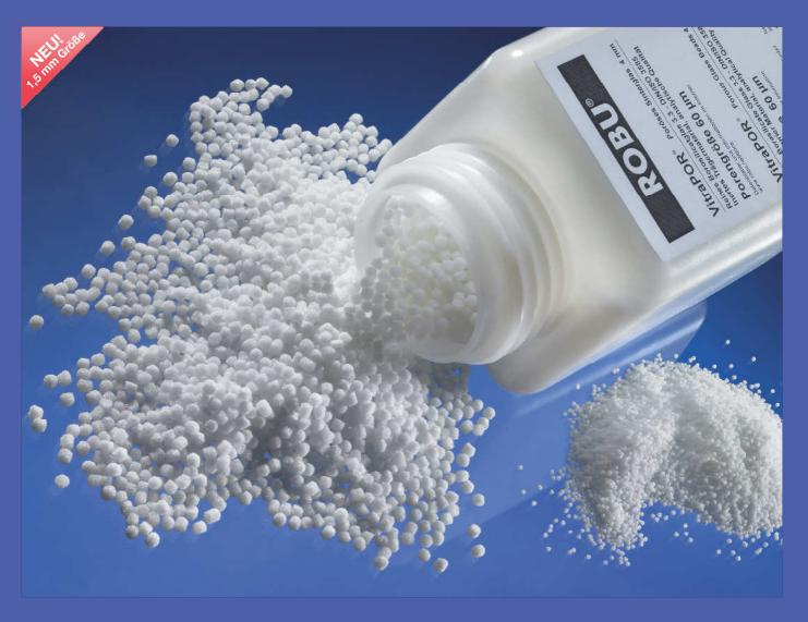
ROBU hat aus der Reihe der bekannten und bewährten VitraPOR Sinterfilterprodukte ein Trägermaterial für die Zellkultivierung in der Biotechnologie entwickelt. Reines, bindemittelfreies Borosilicatglas 3.3 wird mit einer definierten Porengröße von etwa 60 Mikrometern in einem besonderen Verfahren hergestellt und zu gleichmäßigen, porösen Pellets von 1,5 mm oder alternativ 4 mm Größe geformt.
